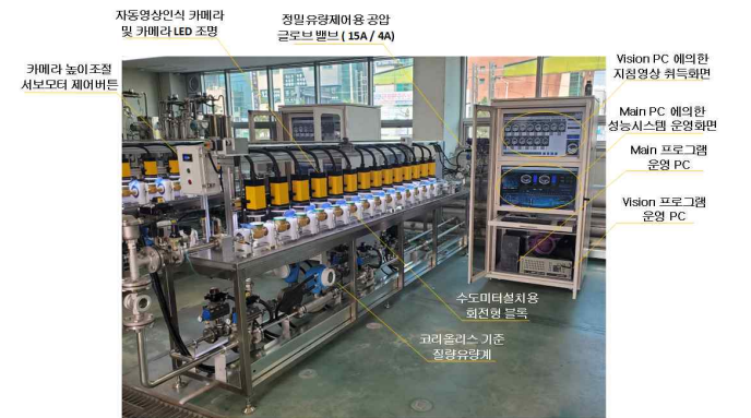
그림 5. 영상인식 자동수도미터 성능 시험장치
